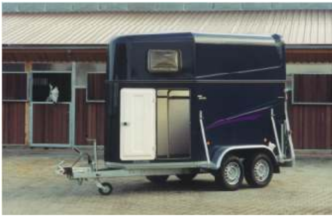
Große Schlupftüre, abschließbar, innen mit Sicherheitsverriegelung (für Tiere nicht zu öffnen).
