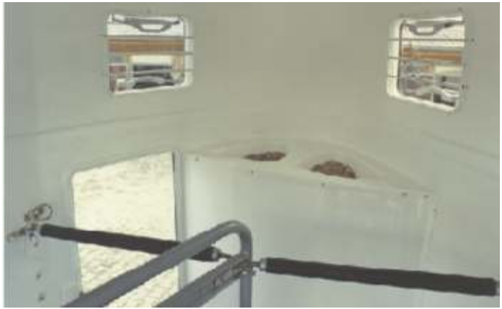
Zweiteilige Futterkrippe, vordere Brustrohre mit Paniksicherung (von außen zu öffnen).
