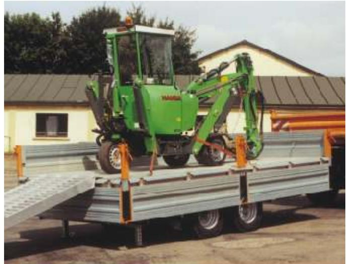
Ladungssicherung **TOPZURR23** serienmäßig. Als Zurrmulden rechts und links in den Rahmen eingearbeitet. Serienmäßig sind insgesamt 10 Stück Anbinderinge bei 4,6m und 12 Stück bei 5,1 m Ladefläche montiert. Die Anbinderinge entsprechen DIN 75410 und können mit 2000daN pro Ring belastet werden.
