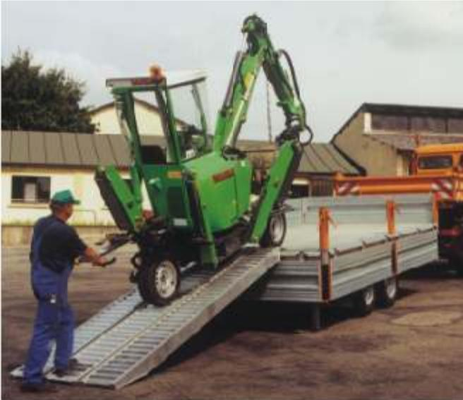
Typ UKD ist der variable Anhänger für Schüttgüter und Maschinentransporte aller Art. Für die Verladung des dreirädrigen Friedhofsbaggers wird eine 3. Auffahrrampe lose mitgeliefert. Die 2 serienmäßigen Alu-Rampen werden in einer Halterung unter der Pritsche eingeschoben.
