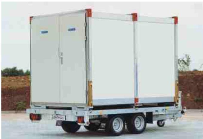
**Niedrigste Ladehöhe - Der isolierte Container in Verbindung mit dem tiefliegenden Plattformanhänger TP:** Mit einer einzigartig niedrigen Ladehöhe wird ein müheloses Be- und Entladen des Kühlcontainers auch auf dem Anhänger ermöglicht.
