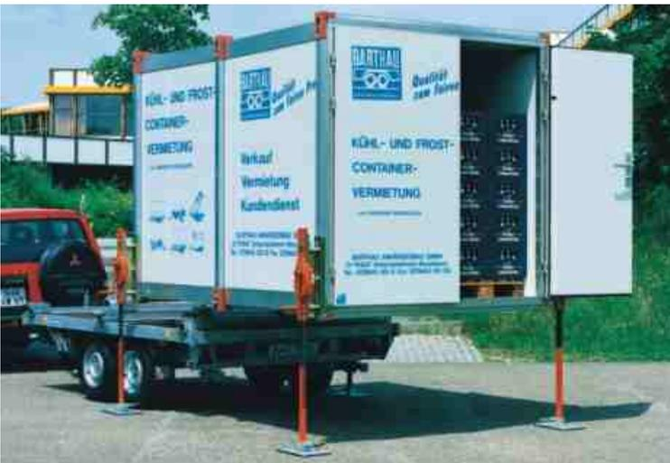
**Einfaches Absetzen** mittels Hebeseystem z.B. am Festzelt - auch per Stapler oder Kran durchführbar!
