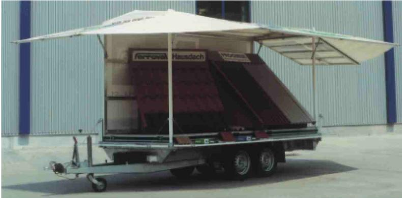
SP 2702 mit Dachgestell und beschriftbarer PVC-Plane, mit Gasdruckdämpfern auf 3 oder 4 Seiten ausklappbar. Die Aluminium-Bordwände können abgeklappt werden oder ausgestellt als Ausstellungsfläche benutzt werden. Die Bordwände sind werkzeuglos auch ganz abnehmbar.
