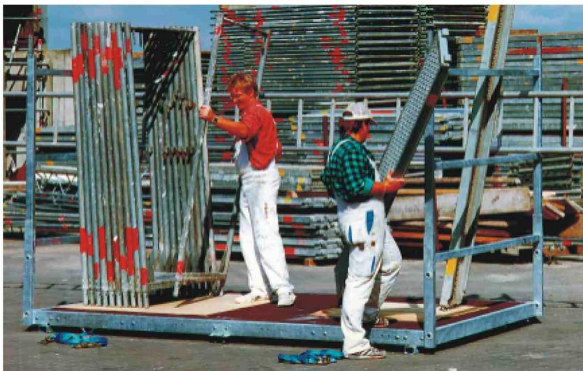
Abgesetzte Arbeitsplattform mit Hochgalerie, dadurch leichte Beladevorgänge. Der Transport-Anhänger kann zeitgleich für andere Zwecke genutzt werden.
