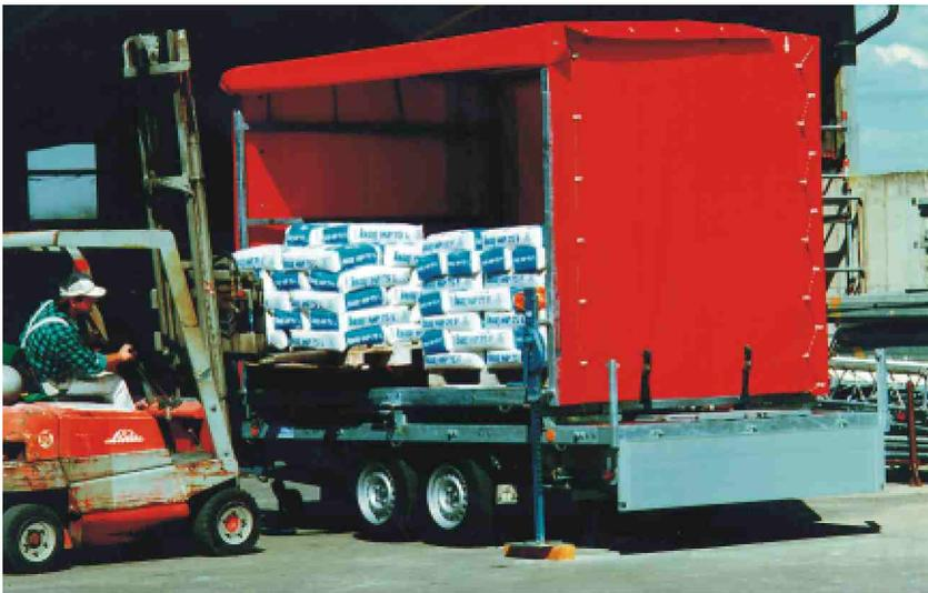
Abnehmbare Arbeitsplattformen auf BARTHAU-Anhänger GH 3502, ausgerüstet mit Planengestell, das einfach auf die Hochgalerie aufgesteckt werden kann. Plane beidseitig hochrollbar.
