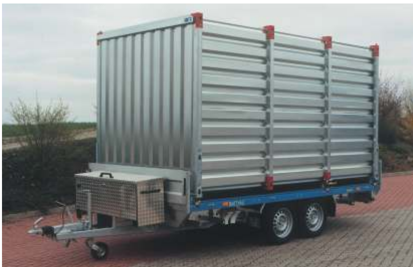
SP 2702 , 4120 x 2120 mm mit Container 4 m/0,75, ausgerüstet zur Aufnahme von Containern, Zubehör: 2 Satz Containerauflagen, 1 Satz Containersicherung, Alu-Riffelblech-Staubbox, Ersatzrad und Ersatzradhalterung.
