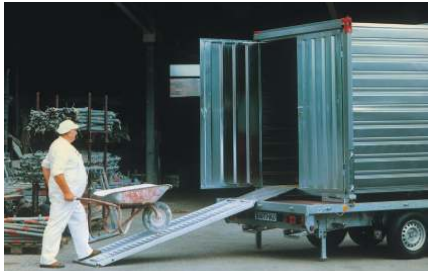
◆ Durch verschiedenes, sinnvolles Zubehör lässt sich der Materialcontainer auf dem Transportfahrzeug oder am Boden stehend leicht begehen oder mit Baugeräten befahren.
