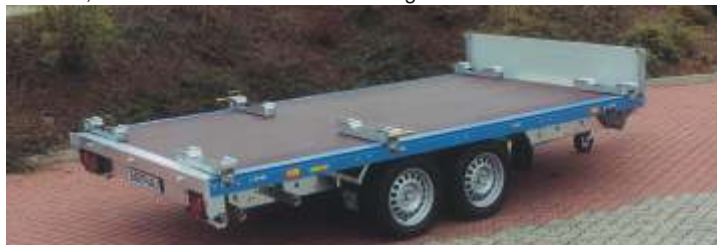
SP 2702 mit Zubehör: 2 Satz Containerauflagen im vorderen und hinteren Plattformbereich, 1 Satz Containersicherung im mittleren Plattformbereich.
