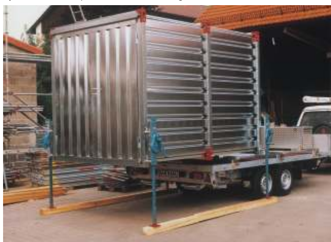
Das Abheben bzw. Absetzen mit dem Hebesystem ist auch in voll ausgeladenem Zustand möglich. Der Anhänger kann anschließend als Nutzfahrzeug in anderen Bereichen sinnvoll eingesetzt werden.
