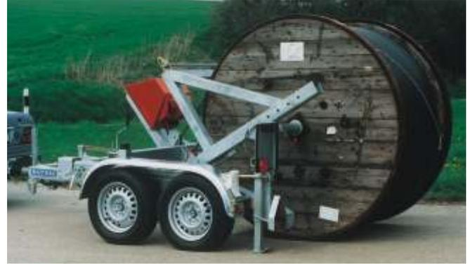
KT 2702 in serienmäßiger Ausführung, u.a. mit Zugseilwinde 2500 kg, schwerem, automatisch umklappbarem Stützrad und Vierkantstützen.
