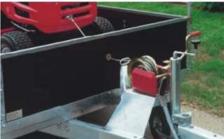
PKL 2002 zusätzlich ausgerüstet mit einer Seilwinde mit 900 kg Zugkraft und stabilem Windenbock, zentral auf den V-Zugholmen montiert, Zugseil durch die Stirnwand geführt.
