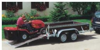
PKL 2002 ausgerüstet mit doppelt umklappbarer Laderampe, mit Alu-Auffahrprofil und Stützfuß, einschließlich Rampenhebern mit Gasfedern und Rohrstützen mit doppelter Klemmhalterung. Zubehör: Laderampe und Boden mit 4 mm-Aluminium-Riffelblech belegt. Links mit Seitengalerie 100 mm hoch, aus Vierkant-Quadratrohr verschraubt, verzinkt, auf die Bordwände steckbar. Rechts mit Gurtleiste seitlich (bei 4010 mm Länge serienmäßig).
