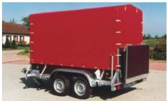
PKL 2702 ausgerüstet mit doppelt umklappbarer Laderampe. Zubehör: Dachgestell, 1400 mm hoch, ab Oberkante Bordwand und PVC-Plane in feuerwehrrot.
