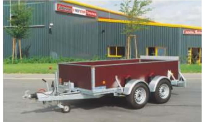
Der gesamte **Aufbau** läßt sich mittels hydraulischer Handpumpe und Hydraulikzylindern nach einem patentierten Verfahren **absenken**. Die **hintere Klappe** ist **überfahrbar** und mit einem **speziellen Auffahrprofil** ausgerüstet. Der Auffahrwinkel ist so flach, daß problemlos beladene Paletten mit Hubwagen oder Ameise auf den Anhänger geschoben werden können.
