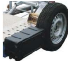
Zubehör: Ersatzrad mit Halterung, am Rahmen montiert. PE-Staubbox, 510 x 220 x 215 mm, abschließbar.
