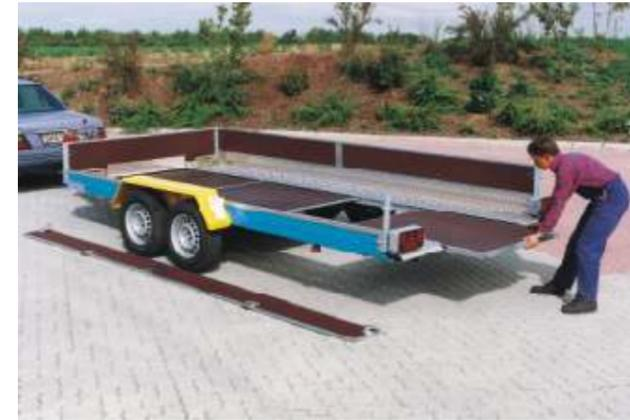
AT 3502 mit Zubehör: Abnehmbare Multiplex-Bordwände, 400 mm hoch, 3-teiliger Zwischenboden aus 21 mm Multiplex-Siebdruckplatten, von hinten einschiebbar.
