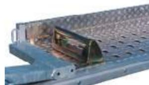
Verstellkeile zur Ladungssicherung über die gesamte Anhängerlänge verstellbar. Gurtösen, am Rahmen angeschweißt.
