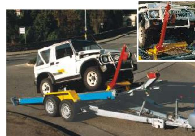
AT 3502 serienmäßig mit schwerem Stützrad. Mit Zubehör: Verladekran zur Bergung von Unfallfahrzeugen. Der Verladekran ermöglicht das Anheben des Fahrzeugs. Evtl. auslaufende Flüssigkeiten können von einer Auffangwanne aufgenommen werden.
