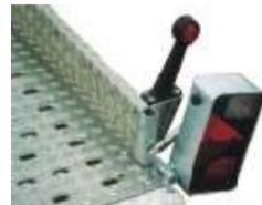
Beleuchtung bei Ladevorgängen ausklappbar. Flache Auffahrkante aus Alu-Riffelblech. Griffige Stanzlochungen, besonders rutschfest!
