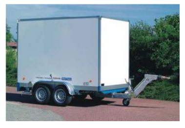
CT 2702 mit Zubehör Verstellbremse: Problemloses Wechseln zwischen verschiedenen Zugfahrzeugen durch höhenverstellbare Auflaufbremse mit LKW-DIN-Zugöse, verstellbar von 400 bis 1100 mm Anhängehöhe. Auf Wunsch mit Kugelkupplung zum Wechseln.
