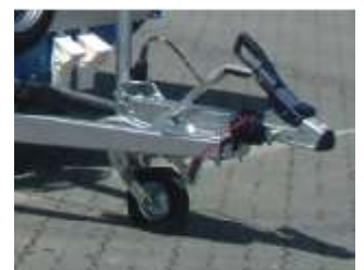
Sicherheits-Anhängekupplung (auf die Kupplungskugel wirkende Beläge unterdrücken Pendelbewegungen während der Fahrt). Für Anhänger bis 3000 kg Gesamtgewicht.
