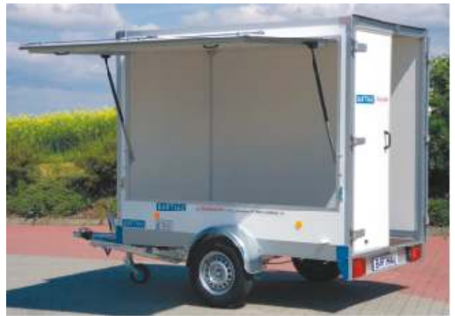
CT 1801 mit Sonderwunsch: Verkaufsklappe links mit großen stabilen Gasfedern und Feststeller, Brüstung 500mm hoch. Serienmäßig von innen verriegelt oder gegen Mehrpreis mit Drehstangenverschluß von außen abschliessbar.
