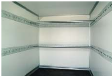
Zubehör Zurrutsche Barthau TOPZURR24 Genauso wie im Rahmenprofil können in der Barthau Zurrutsche die Nockenfitting auf die ganze Länge und vorne montiert werden. Zusätzlich können auch Absperrstangen rund verzinkt auf die ganze Länge und auf 2 Höhen eingesetzt werden. Diese optimale Ladungssicherung ist für jede Ladung nutzbar und unentbehrlich.
