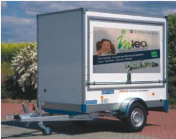
CT 1801 mit Sonderwunsch: Verkaufsklappe links mit großen stabilen Gasfedern und Feststeller, Brüstung 500mm hoch. Serienmäßig von innen verriegelt oder gegen Mehrpreis mit Drehstangenverschluß von außen abschliessbar.
