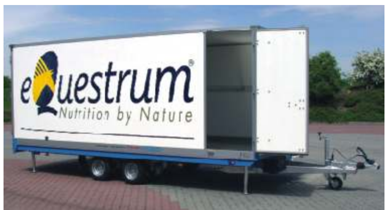
CH 2702 mit Zubehör: Sonderhöhe von 1850 mm Innenhöhe. Vorne rechts mit einer Seitentüre 750 mm breit, mit Gummidichtprofil, unten ca. 10cm Schwelle, mit Drehstangenverschluß von außen abschließbar. Ersatzrad und Staubbox vorne an der Stirnwand montiert, Sicherheitskupplung und 4 Stk. Klappkurbelstützen mit separater Kurbel hinten und vorne montiert.
