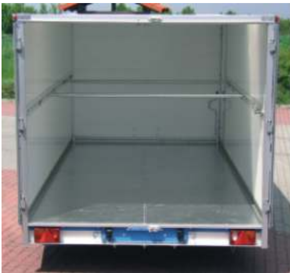
Zubehör: Boden mit 1,5 mm Alublech belegt. Zusätzlich wurden beidseitig seitlich 1 m über den Anhängerboden noch Zurrutschen für TOPZURR24 montiert. In dieser Zurrutsche können Nockenfitting oder Absperrstangen eingehängt werden.
