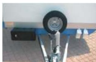
**Ersatzrad mit Halterung** vorne an der Stirnwand montiert.
