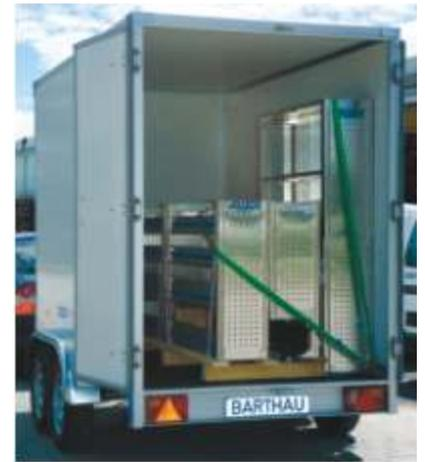
CT 2002 serienmäßig mit Zurrleiste **TOPZURR24** am Rahmen seitlich und hinten. Sicherer Transport ohne Beschädigungen. Stabile Aluminiumscharniere zollsicher verschraubt. Türen mit Drehstangenverschluss abschließbar. Hinteres Portal stabil und superleicht weil vollkommen aus Aluminium.
