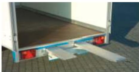
CT 2702 befahrbar mit Aluminium-Rampen Typ RL 2000 mm lang, 220 mm breit, Tragkraft lt. Prospekt 0.2. Die Rampen haben eine griffige Lauffläche und sind durch eine Bolzenarretierung gegen Abrutschen gesichert. Zum Transport werden die Rampen in einer Halterung unter der Ladefläche eingeschoben.
