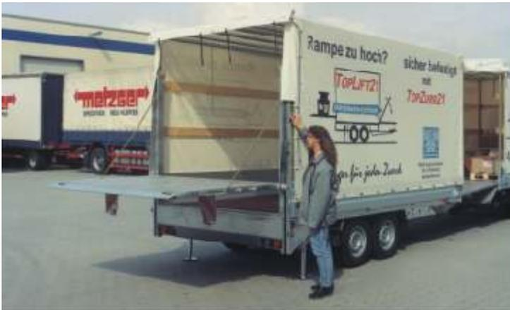
**Lift 3502** ist der BARTHAU Speditionsanhänger mit angebauter elektrohydraulischer Ladebordwand. Fahrgestell, Rahmen und Aufbau entsprechen dem Typ SP.
