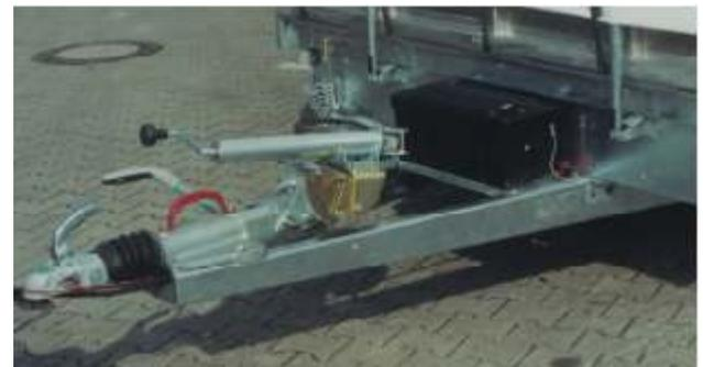
Beim Abklappen der Überfahrbordwand wird das schwere Stützrad inkl. stabiler Halterung einfach waagrecht geklappt.
