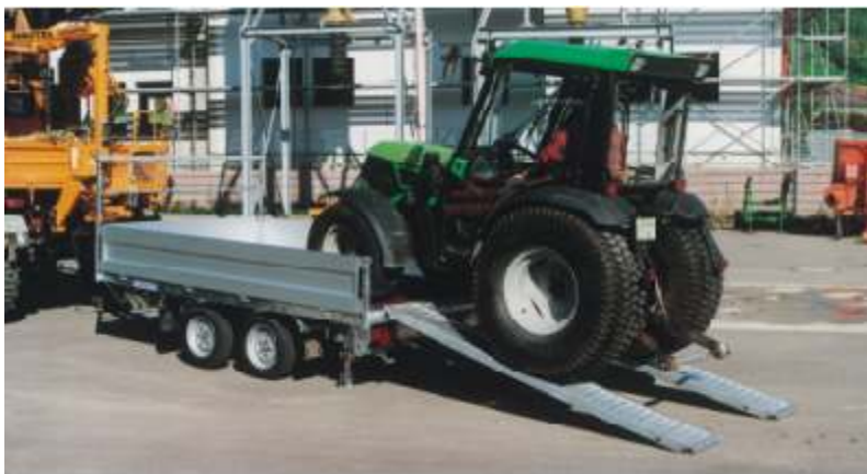
Aluminium-Auffahrrampen, unter der Pritsche eingeschoben, Klappstütze mit Federriegelsicherung.
