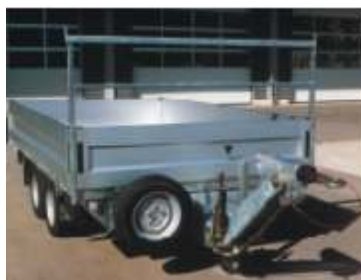
GH mit Bereifung 155/70R12 mit Zubehör: Höhenverstellbare Auflaufbremse mit DIN-Zugöse, wechselbar gegen Kugelkupplung, Ersatzrad vorne montiert wegen Klappstützen hinten, H-Galerie mit Holzeinlage.
