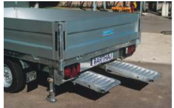
Aluminium-Auffahrrampen, unter der Pritsche eingeschoben, Klappstütze mit Federriegelsicherung.
