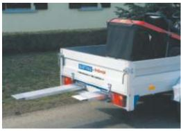
QL 2702 befahrbar durch Aluminium-Rampen Typ RL 2000 mm lang, 220 mm breit, Tragkraft It. Prospekt 0.2. Die Rampen haben eine griffige Lauffläche und sind durch die Bolzenarretierung gegen Abrutschen gesichert. Zum Transport werden die Rampen beim QL 2702 in einer Halterung unter der Ladefläche eingeschoben.
