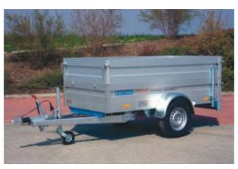
**QL 1501** mit Zubehör: **Aluminium-Aufsatz 400 mm hoch**, Rohrstützen mit einfacher Klemmhalterung, beidseitig und Stützrad schwer.
