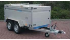
QL 2002 mit Zubehör: Bordwände um 400 mm erhöht auf 800 mm. Mit Ladungssicherung *TopZURR24* serienmäßig im Rahmen. Zusätzlich kann noch eine Zurrleiste an den Bordwänden montiert werden.
