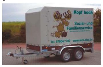
**Dachgestell** 1600 mm oder 2000 mm Ladehöhe, windschnittig vorne abgeschrägt mit niedrigem  $c_{\rm w}$ Wert. Dachgestelle serienmäßig mit Vierkantrohren verschraubt, deshalb leicht zerlegbar. Alle Teile gegeneinander austauschbar.
