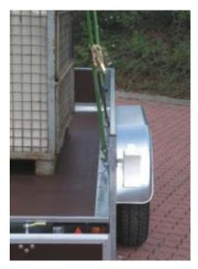
**TOPZURR24** das innovative Rahmensicherungssystem von BARTHAU. Keine Belastung der Seitenwände - direkte Einleitung der Zurrkräfte in den Rahmen. Die Nockenfittings sind versenkt montiert - volle Nutzung der gesamten Ladefläche.
