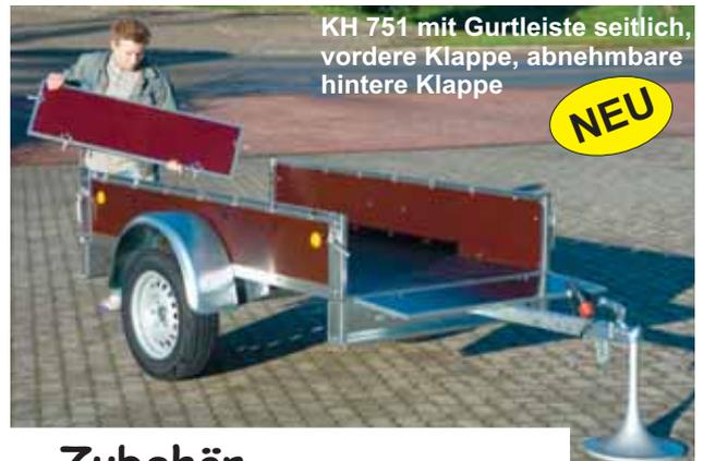
KH 751 mit Gurtleiste seitlich, vordere Klappe, abnehmbare hintere Klappe
